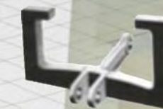
O-Glied mit ausgebrannten oder geschmiedeten, angeschweißten Mitnehmern.
